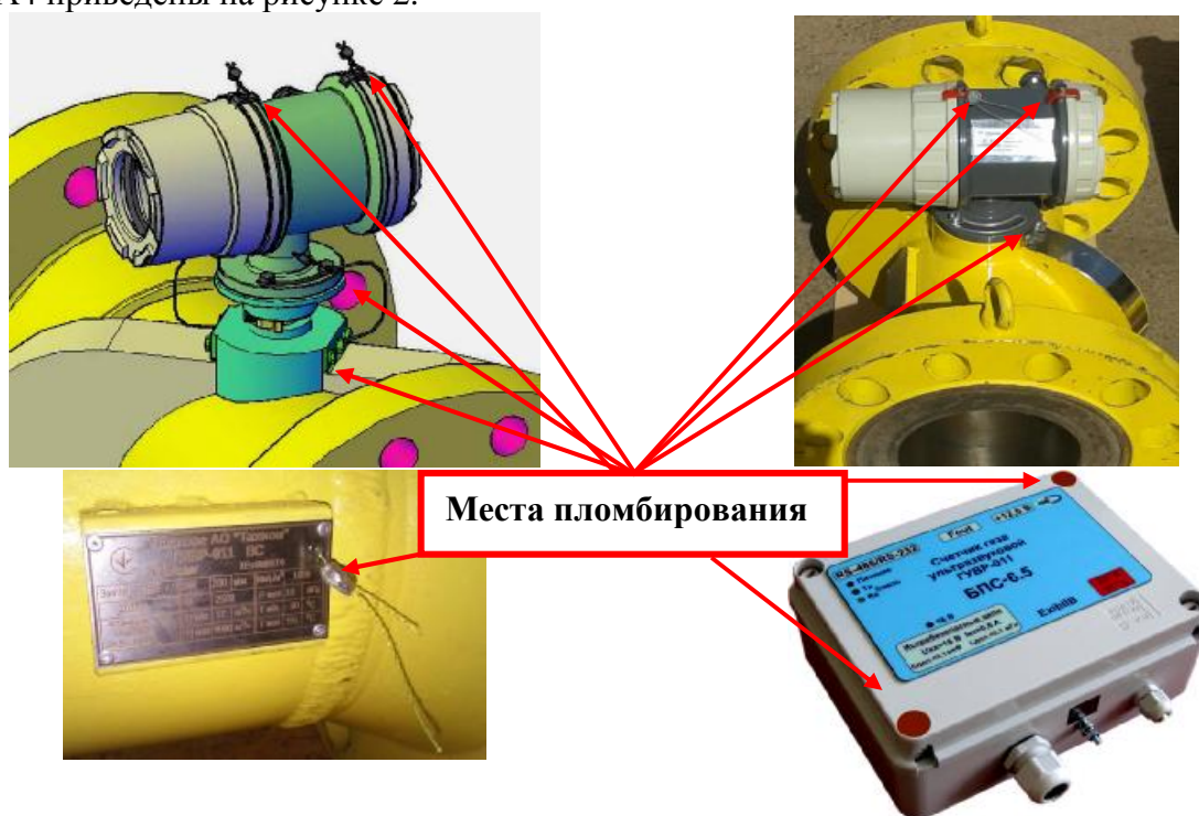
Рисунок 2 – Места нанесения знака поверки счетчиков газа ультразвуковых ГУВР-011 модификации А4
