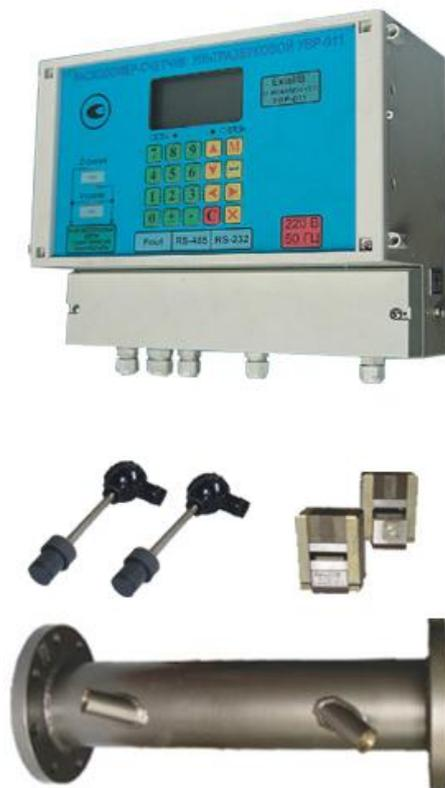
Расходомер УВР-011 А2-К предназначен для измерения в напорных трубопроводах расхода жидкостей условно «чистых», таких как хоз.-питьевая вода, речная вода, растворы кислот и щелочей, а также жидкостей типа аммиак, селитра, нефть нефтепродукты и т.п. Адаптирован для работы в составе АСУ, но может применяться и в автономном режиме.
