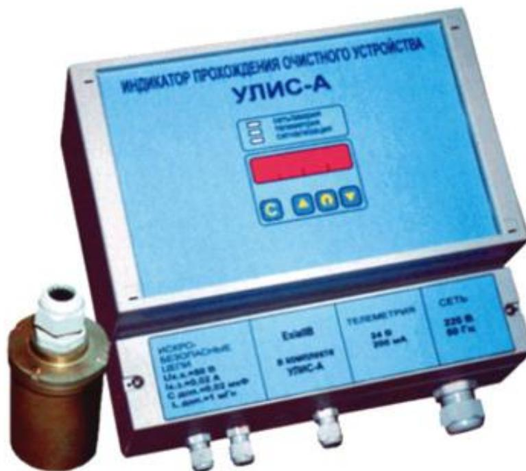
**Индикаторы УЛИС, УЛИС-А** предназначены для обнаружения очистных устройств («скребков»), перемещающихся в напорных (полностью заполненных) трубопроводах под влиянием потока жидкости. Индикаторы являются телеметрическими датчиками для оснащения нефтепроводов. Индикаторы разработаны для нефтепроводов, изготовленных из стальных труб с толщиной стенки до 20 мм.
